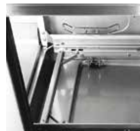
Parede dupla da cuba completamente estampada, filtro duplo de aço e câmara de lavagem sem tubos internos.
