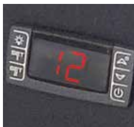
Termóstato para regular a temperatura com ecrã digital. Após fixar a temperatura, a regulação faz-se eletronicamente.
