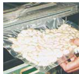
Possibilidade de realizar a embalagem a vácuo de forma exterior, o que permite embalar produtos de grande comprimento.
