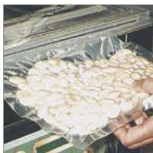
Possibilidade de realizar a embalagem a vácuo de forma exterior, o que permite embalar produtos de grande comprimento.
